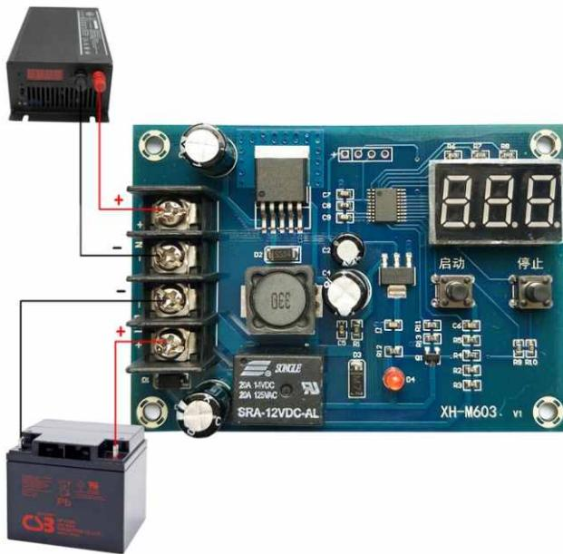
Модуль является не зарядным устройством, а контроллером, который подключает и отключает зарядное устройство к аккумулятору.
